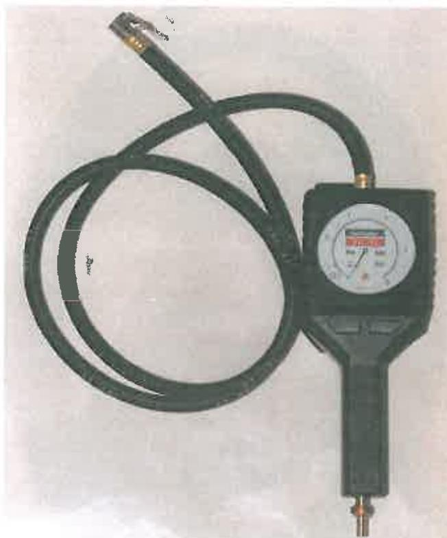
*Manomètre pour pneumatiques des véhicules*
